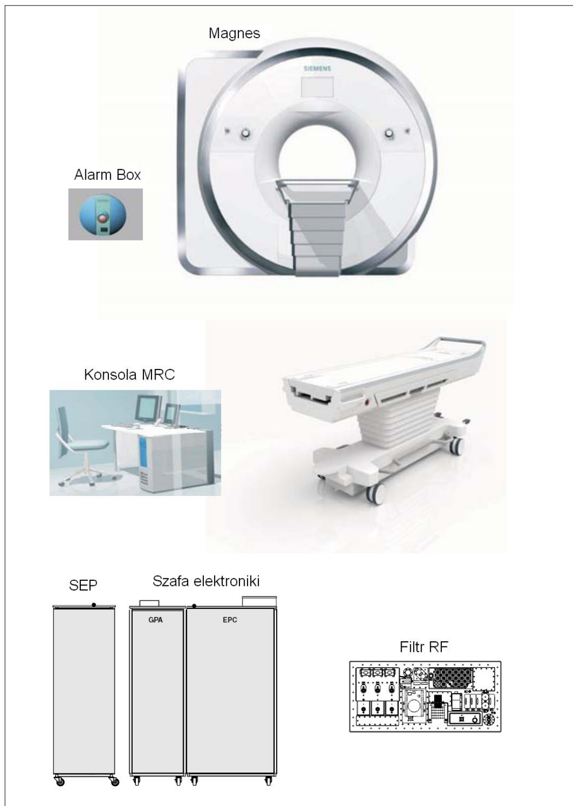
Rys. 1.2. Elementy składowe systemu MAGNETOM Skyra przy układzie chłodzenia zapewnionym przez Zamawiającego
